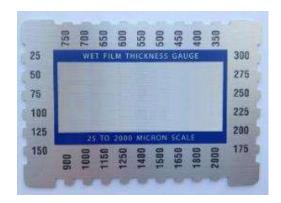
Pressione o lado apropriado do medidor no filme molhado imediatamente após a aplicação
